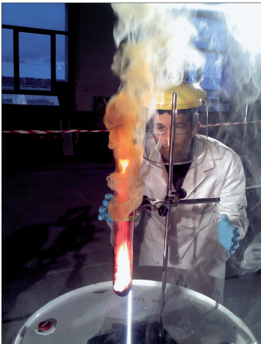
Figura 4. L'espectacular experiment amb brom i alumini genera una gran quantitat de vapors de tribromur d'alumini en una reacció altament exotèrmica.
