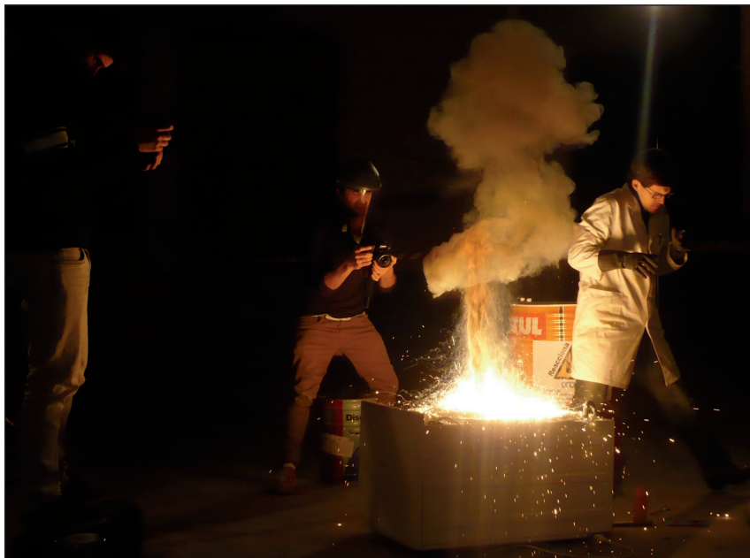
Figura 5. La reacció termita és una espectacular reacció en què s'obté ferro fos i que permet foradar planxes metàl·liques com la d'aquesta rentadora.
