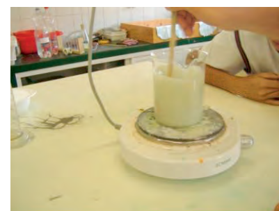
Figura 3. Preparación de la disolución de dihidrogenofosfato de amonio.
