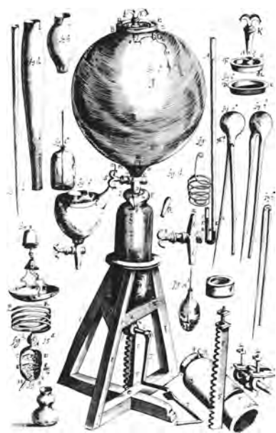
Figura 1. Il·lustració de la primera bomba de buit de Boyle mostrant els seus components.
