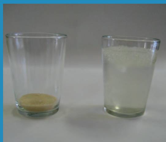
Figura 6. O poliacrilato de sódio (sólido no copo à esquerda), um polímero superabsorvente, absorve cerca de 300 vezes sua massa em água, produzindo um gel.
