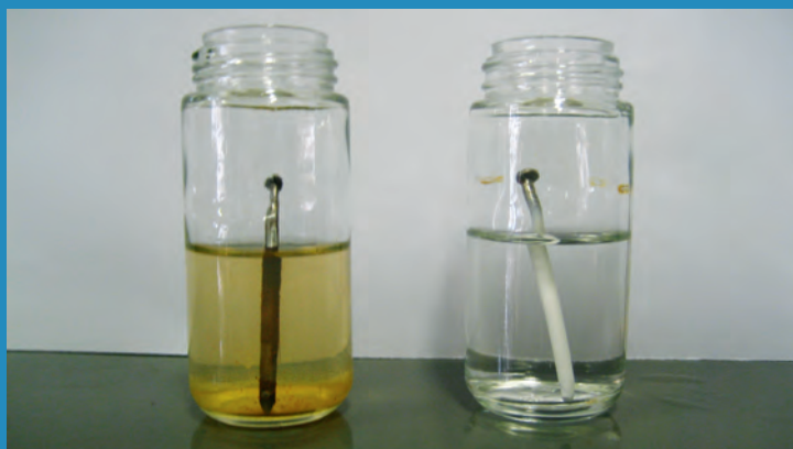
Figura 11. As tintas funcionam como uma barreira na prevenção da corrosão do ferro no meio ambiente.
