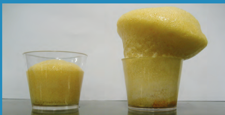
Figura 5. A reação de quantidades iguais de um diisocianato e etileno-glicol produz uma espuma do tipo poliuretana.
