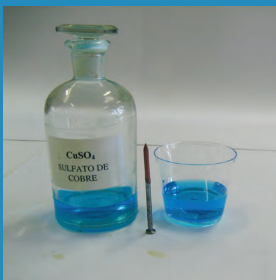
Figura 12. A deposição espontânea de cobre metálico ocorre quando um prego de ferro é colocado em uma solução de sulfato de cobre.
