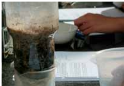
Figura 4. Filtre de sorra i grava.
