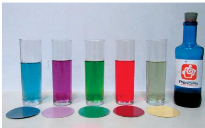
Figura 2. Experiencia «La tinta camaleónica», utilizando como indicador la col lombarda.
