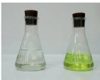
Figura 13b. Tras un tiempo, el azul de metileno se reduce, por lo que queda incolora la disolución y el que contenía 4-nitrofenol aparece amarillo.
