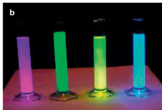
Figura 12. Las probetas contienen luminol en medio básico con diferentes colorantes cromóforos. Al añadir la disolución de ferricianuro de potasio y agua oxigenada, se produce la luminiscencia.
