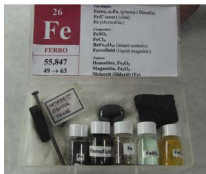
Figura 1. En aquesta fotografia, podem veure la capsa de l'element ferro. En ella podem veure la substància simple, els compostos i objectes diversos que il·lustren alguna de les seves aplicacions.
