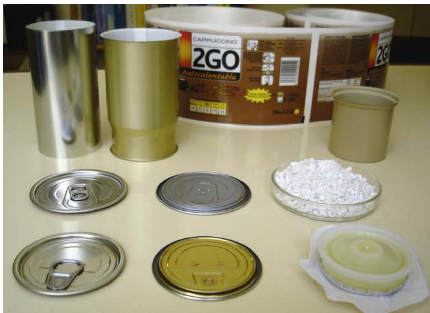
Figura 3. Conjunto de piezas y reactivos que forman el envase de la bebida autocalentable analizada.
