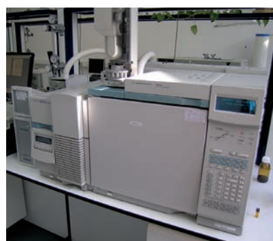
Figura 8. Cromatògraf de gasos acoblat amb espectrometria de masses (CG-MS) utilitzat a l'empresa Solvay.
