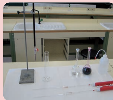
Figura 1. Material i muntatge per a la determinació de matèria orgànica oxidable.
