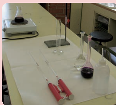
Figura 1. Material i muntatge per a la determinació de matèria orgànica oxidable.
