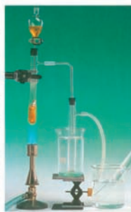
Rys. 12.6. Ogrzewanie oleju napędowego bez selata prowadzi do powstania benzyny i gazów krakowych.
