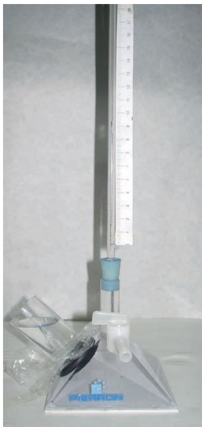
Osmometre emprat per veure l'efecte de l'osmosi.
