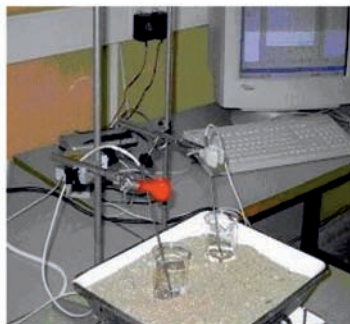
Figura 2. Vasos amb acetona i etanol escalfant-se en un bany de sorra construït amb materials casolans, amb els sensors de temperatura a l'interior. A la dreta, s'hi poden veure els resultats obtinguts de l'experiència
