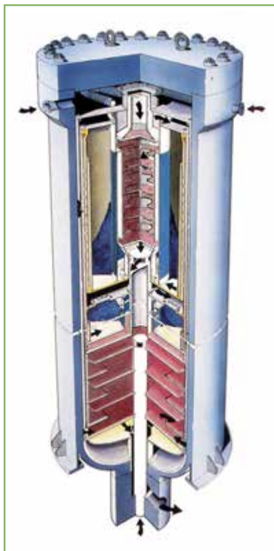
Figura 4. Esquema d'un reactor catalític industrial actual per a la síntesi de l'amoníac mitjançant la reacció de Haber-Bosch.
