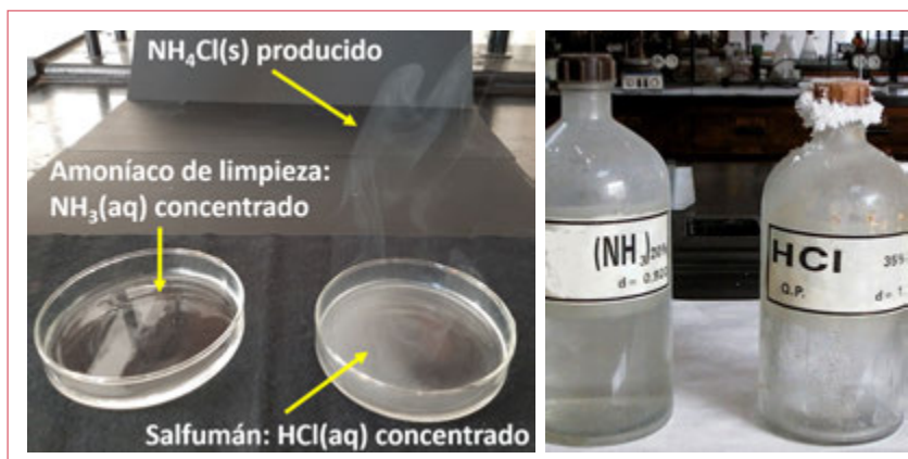
Figura 1. Formación de NH 4 Cl(s): a la izquierda en forma de microcristales que producen una «neblina» y a la derecha en el tapón de la botella con HCl(aq).
