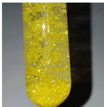
Figura 6. Sup.: El PbI_2 precipita cuando se mezclan KI(aq) y Pb(NO_3)_2(aq) (Creative Commons, por PRHaney, 2008). Inf.: Recristalización de PbI_2 por enfriamiento de su disolución (Creative Commons, por Stefano sct, 2015).
