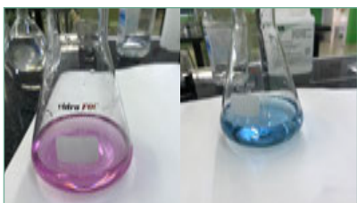
Figura 3. L'erlenmeyer de la dreta mostra el punt final de la valoració de la duresa.
