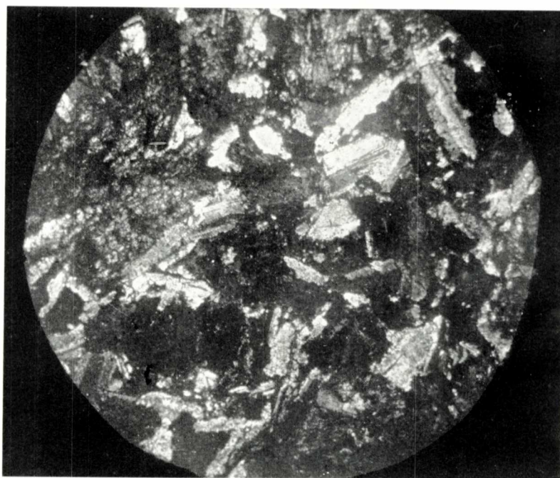
Fig. 2.—Diabasa uralítica de Sant Feliu de Llobregat (riera de la Salut). N. + 15 diám. Estructura diabásica con cristales de labrador y uralita.
