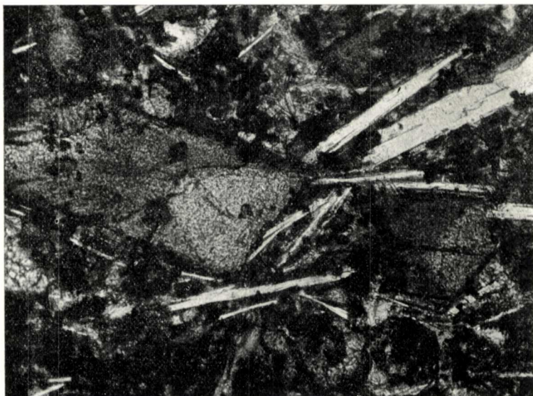
Fig. 1. Basalt plagioclàsic-Traquidolerita del Mas Ral. L. ord. 60 d. Dos cristalls d'augita amb estructura en rellotge d'arena (sablier), microlits de Labrador, cristalls i granets d'augita i magnetita.
