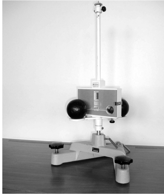
Figura 2. La balance de gravitation miniaturisée utilisée en enseignement. Remarquer le petit miroir solidaire du fléau, permettant d'utiliser la méthode de Poggendorf.
