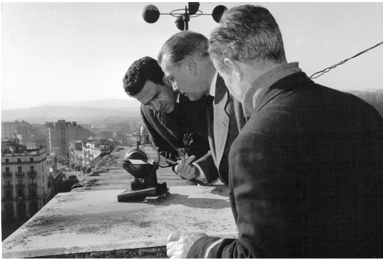
Figures 1 i 2. Dues imatges de l'observatori meteorològic dels anys cinquanta o primers seixanta. Es veu el catedràtic de física i director de l'observatori des de 1940, Josep Gener Salord, ensenyant els aparells que es trobaven al terrat de la torre als observadors. A la part superior, el pluviògraf d'intensitats. A la part inferior, l'heliògraf de Campbell-Stokes. A la part posterior de la fotografia es veu el sensor de l'anemòmetre.
