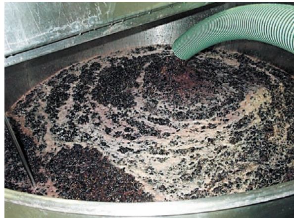
Figura 3. Dipòsit de vi negre durant un remuntatge. Surant sobre el líquid es troba el barret, format per les pellofes del raïm. El remuntatge consisteix a bombejar líquid des de la part inferior del dipòsit fins la part superior per tal de facilitar l'extracció del color i d'altres components de les pells. Els enzims de maceració s'utilitzen per a augmentar el rendiment d'aquest procés.
